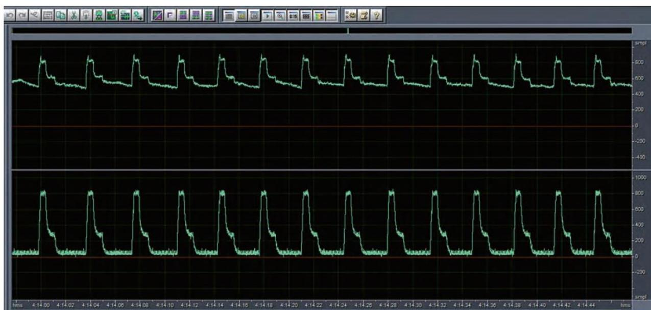
Новейшая технология системы управления формой волны с режимом управления импульсной MIG-сваркой позволяет полностью контролировать выходную мощность сварки и обеспечивает точную работу с дугой. Во время сварки используется простой цикл переноса расплавленной капли проволоки с минимальным количеством брызг.
