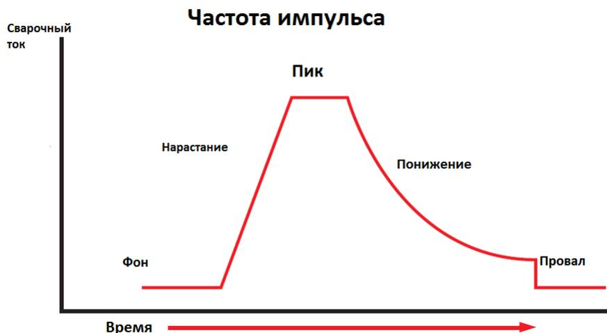
Импульсная MIG-сварка изменяет сварочный ток между пиковым (высокий нагрев) и фоновым (низкий нагрев) током для обеспечения лучшего контроля за тепловложением, тем самым сводя к минимуму деформацию и прожог тонких материалов. Импульсная MIG-сварка возможна в разных пространственных положениях.
