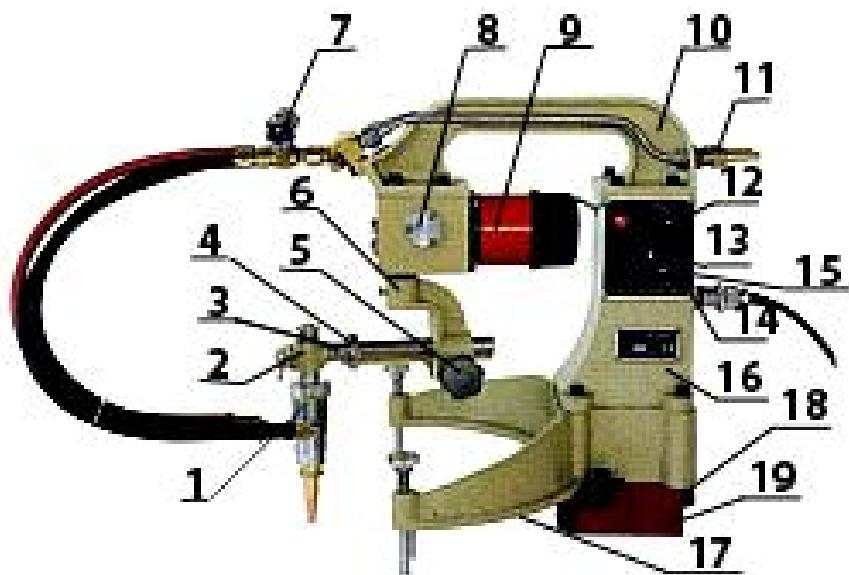
**Машина состоит** из корпуса с магнитной опорой, редуктора с электродвигателем, газораспределительной системы, резака и следующих элементов:
